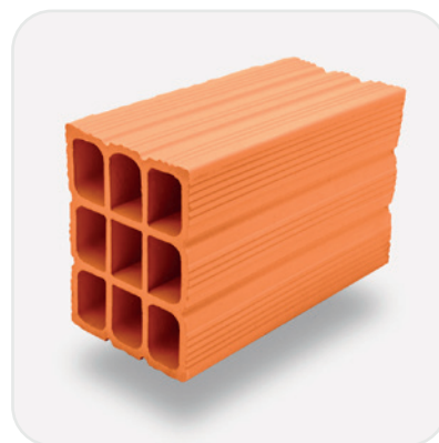
Bloco de Vedação 14 x 19 x 29 Rendimento: 16,5 peças/m 2
