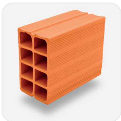
Bloco de Vedação 11,5 x 19 x 24 Rendimento: 20 peças/m 2
