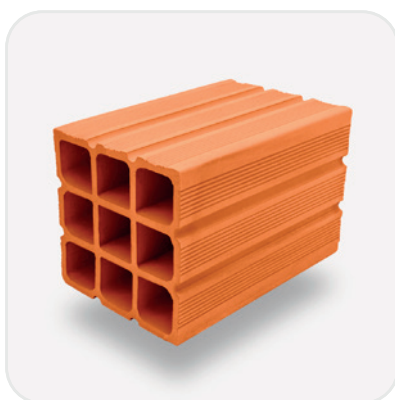
Bloco de Vedação 19 x 19 x 29 Rendimento: 16,5 peças/m 2
