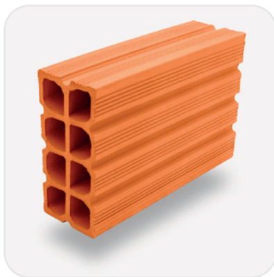
Bloco de Vedação 9 x 19 x 29 Rendimento: 16,5 peças/m 2
