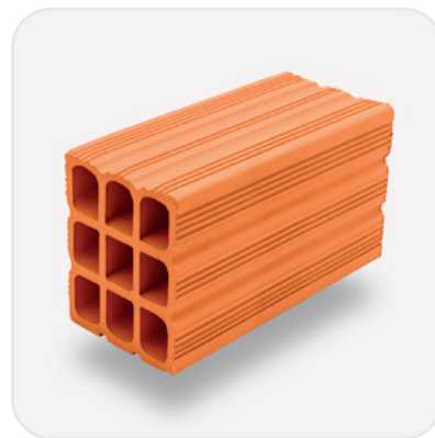
Bloco de Vedação 11,5 x 14 x 24 Rendimento: 26,5 peças/m 2
